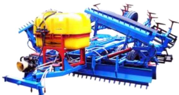
Агрегат для внесения гербицидов АВГ- 8 предназначен для одновременного выравнивания почвы, внесения почвенных гербицидов в защищенной от порывов ветра зоне специальными кожухами, культивации и заделки в почву гербицидов под посев технических культур. Агрегат работает в диапазоне температур от ... градусов до +..., влажности почвы ...%, твердости грунта ...МПа.
