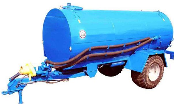
АПВ – емкость с центробежным насосом. Предназначена для самозаправки, транспортирования, раздачи воды на животноводческих фермах, в летних лагерях и на выгульных площадках. Возможно использование емкости для перекачки воды и других жидкостей, мойки животноводческих помещений и сельхозмашин.
