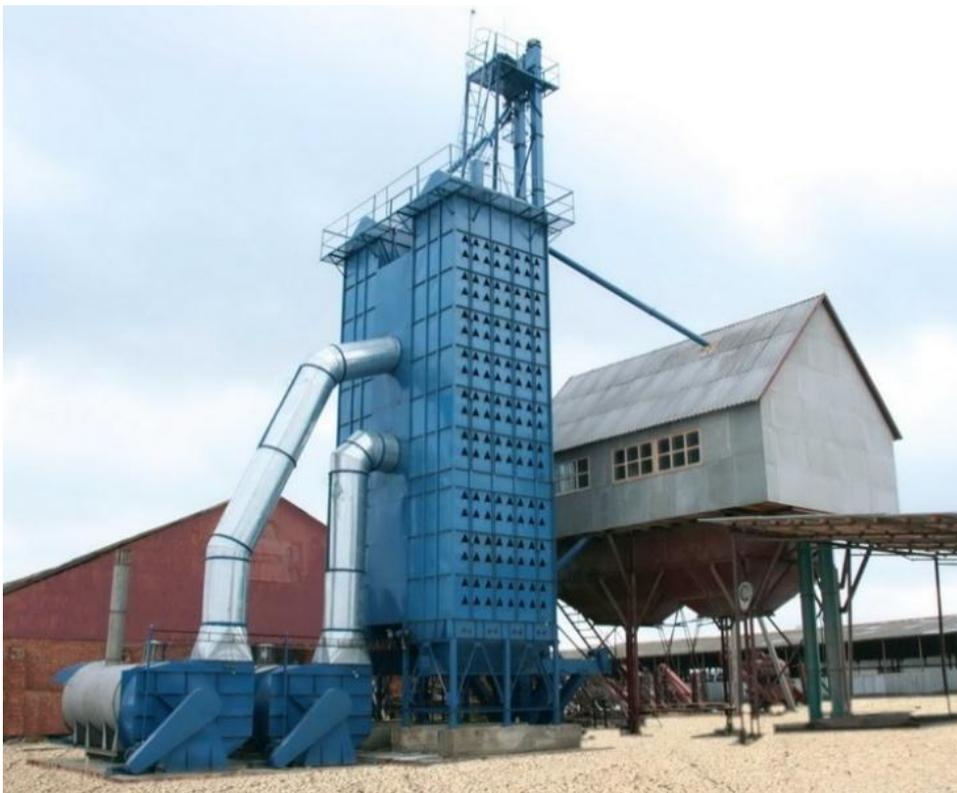
В процессе послеуборочной обработки зерна в большинстве регионов одной из важных операций является сушка зернового материала с помощью зерносушилок.
