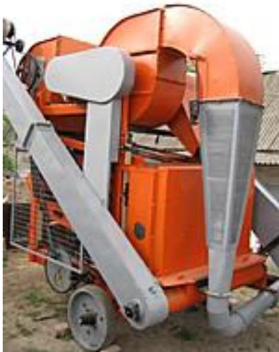
Машина предназначена для предварительной и первичной очистки зернового вороха колосовых, крупяных и зернобобовых культур, технических и масличных культур и семян трав от легких, крупных и мелких сорной и зерновой примесей, с целью доведения содержания примесей в заготавливаемом зерне до базисных кондиций.
