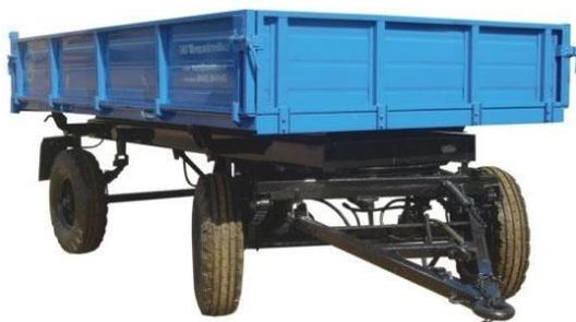
Прицеп тракторный 2ПТС-4 используется в основном в сельском хозяйстве. Он предназначен для перевозки грузов как в поле, так и по общественным дорогам. Имеет трехстороннюю выгрузку с подъемом платформы до ... градусов. Агрегируется с колесными тракторами тягового класса ... т.с., которые оборудованы пневно и гидро системой.
